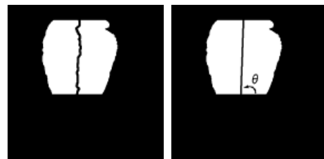
図5 左図：水平方向における各中点座標 右図：回帰直線による回転角度 \theta の算出
