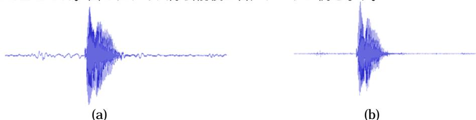
図 2. 低周波ノイズ除去前の音声データ(a)、低周波ノイズ除去後の音声データ(b)
